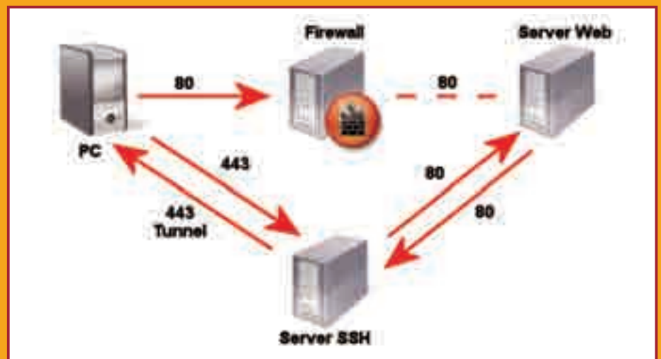
▲ Lo schema di principio del funzionamento di un tunnel SSH. Adottando un sistema come questo nessun firewall può fermare le nostre comunicazioni.
